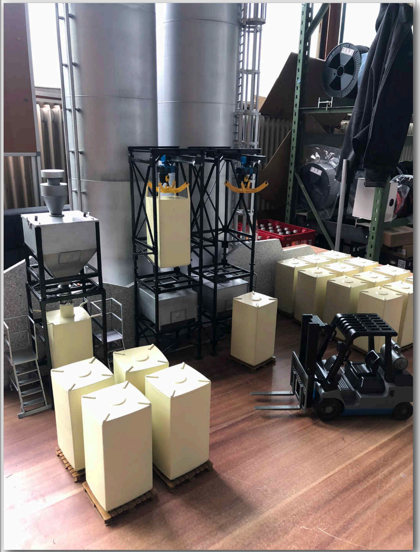
Messemodell hergestellt im SLS-Verfahren und lackiert
