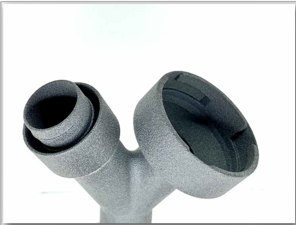
Prototyp hergestellt im SLS-Verfahren
